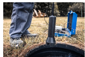
Mesure de boue d'une fosse
